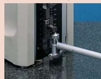
Fijado del cero en un Bore Gage
