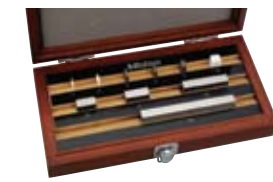
Juego de 10 Bloques Patrón combinación de CERÁMICA/Acero
