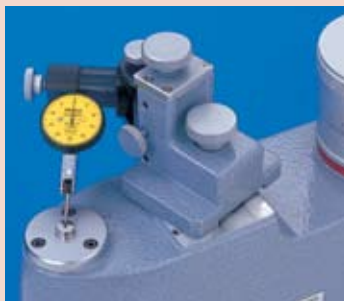
Calibrando un indicador de carátula tipo palanca
