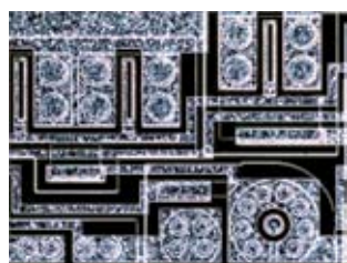
Observación con campo oscuro (BF): Observando sólo la luz dispersa apagando la luz directa a los objetivos. Las rayaduras y polvo que no pueden ser vistas con campo se pueden observar mediante un alto contraste.
