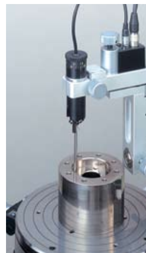
Medición dentro de diámetro interior
