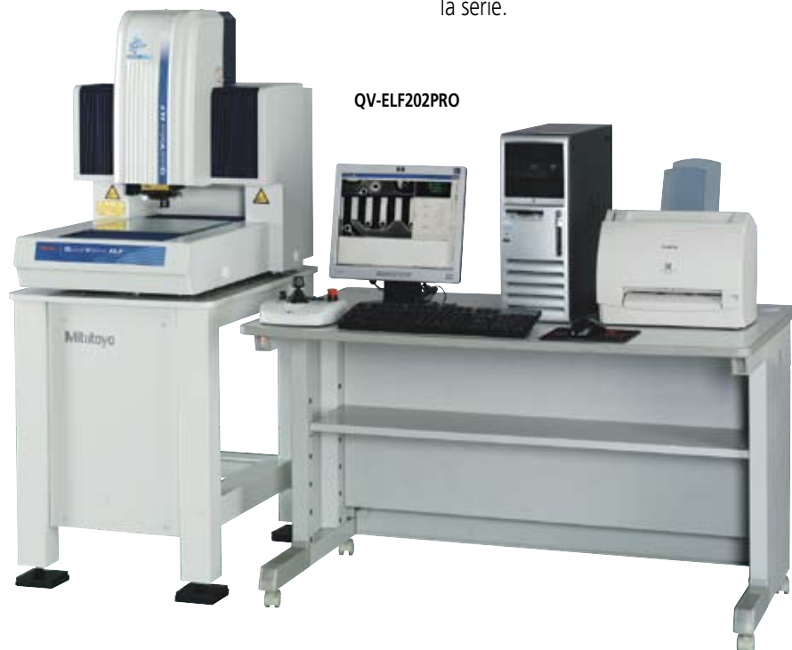
Lente de 2X y objetivo de 2.5X Campo de visión: 1.25 x 0.94mm
