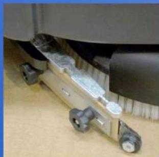
JALADOR PARABÓLICO CON HULES MUY FÁCILES DE CAMBIAR. EL PLATO DEL CEPILLO Y SU JALADOR ASEGUAN LA PRESIÓN ADECUADA PARA LA LIMPIEZA DE CUALQUIER TIPO DE SUPERFICIE.
