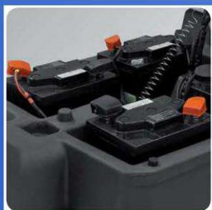
EL TANQUE DE AGUA DEL DETERGENTE SIRVE COMO COMPARTIMENTO PARA LAS BATERÍAS, DEJANDO UNA GRAN CAPACIDAD DE ESPACIO PARA LAS BATERÍAS, ASÍ PODER TENER MAYOR TIEMPO DE TRABAJO CONTINUO. CON UNOS TANQUES DE POLIETILENO CAPACES DE RESISTIR ÁCIDOS Y GOLPES, Y CON SU GRAN CAPACIDAD (110 LITROS) EVITAMOS EL CONTINUO LLENADO DE LOS TANQUES.
