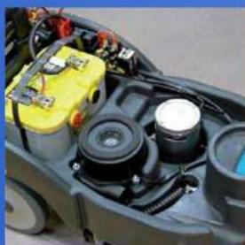
FÁCIL ACCESO A LAS PARTES MECÁNICAS (PARA EL SENCILLO MANTENIMIENTO DE SUS COMPONENTES), EL TANQUE DE RECUPERADO SE PUEDE QUITAR SIN EL USO DE HERRAMIENTAS.
