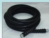
Manguera de doble malla de acero de 10 mts, D.I. 5/16" Con presión de operación de 5800 psig, 160°C.
