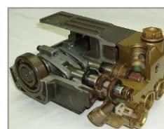
Bomba de cigüeñal y bielas, que es de mucho mejor calidad y de un uso mas rudo que una bomba axial o de plato inclinado, con resortes.
