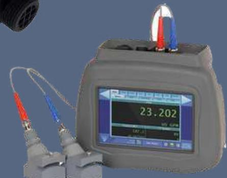
**El principio clave del método aplicado es que las ondas sonoras propagándose en el sentido del flujo se moverán más rápidamente que aquellas en contra de este. La diferencia en el tiempo de tránsito de estas señales es proporcional a la velocidad del líquido y, consecuentemente, al rango volumétrico del flujo.**
